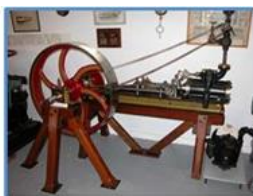
Início da máquina ferramenta com vapor, polias e correias
